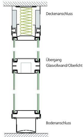
Das verzinkte Stahlskelett beim System 82 kann beidseitig mit einer 13 mm starken Melaminbeschichtung oder mit einer echtholz furnierten Qualitäts-Spanplatte beplankt werden. Als Höhenausgleich besitzt das System 82 einen zurückspringenden Sockel mit Pulverbeschichtung. Die Stahlrahmenfenster können mit Einfach- oder Doppelverglasung bestückt werden.
